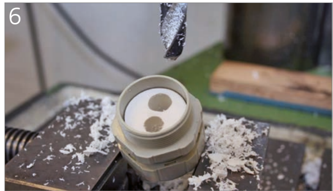
6 Zweite Bohrung in der Ansicht von unten
