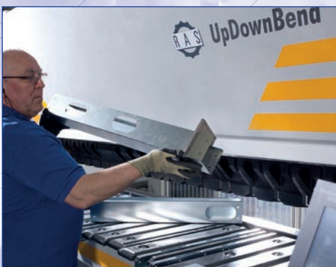
Bearbeitung von Industriekanälen Machine processing of trunkings Usinage de chemin de câble
