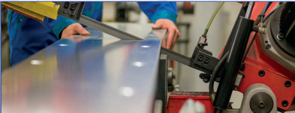
Ablängen von Pflitsch Industriekanälen Cutting to length of Pflitsch Industrial Trunkings Découpage en longueur des chemin de câbles Pflitsch
